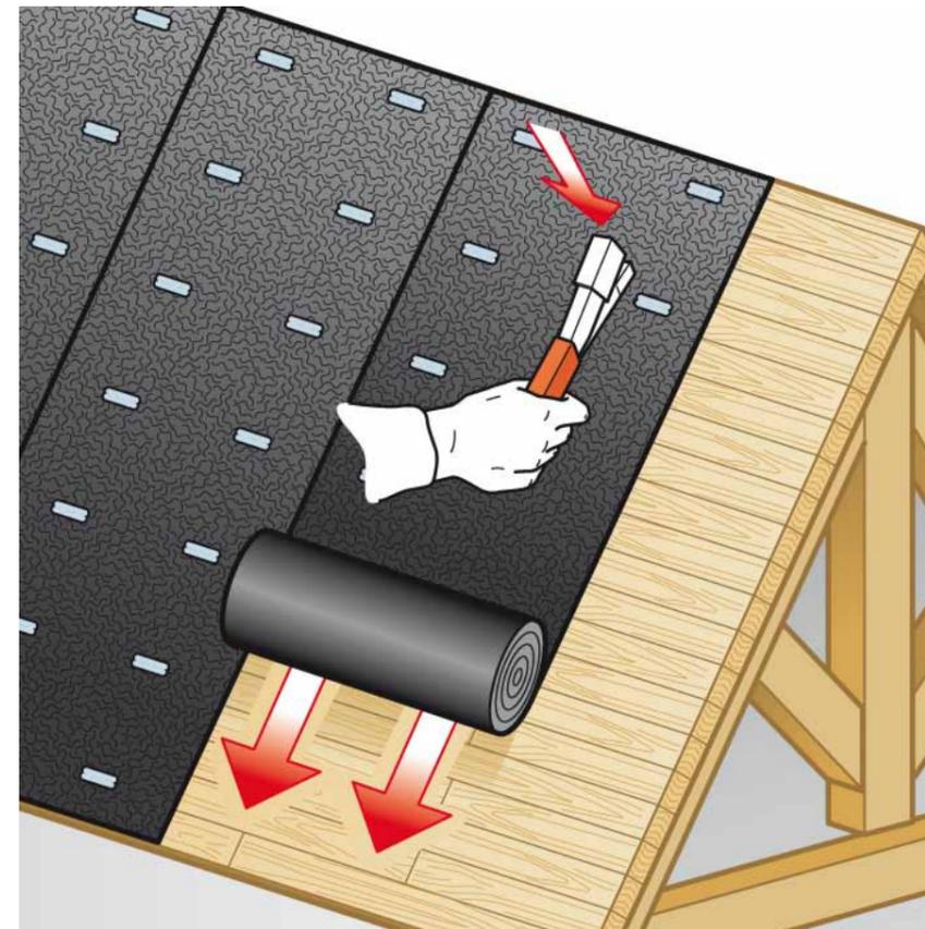
**3.** K-Vent easy kann auf die Holzschalung mit Dachpappennägeln bzw. Heftklammern fixiert werden.
